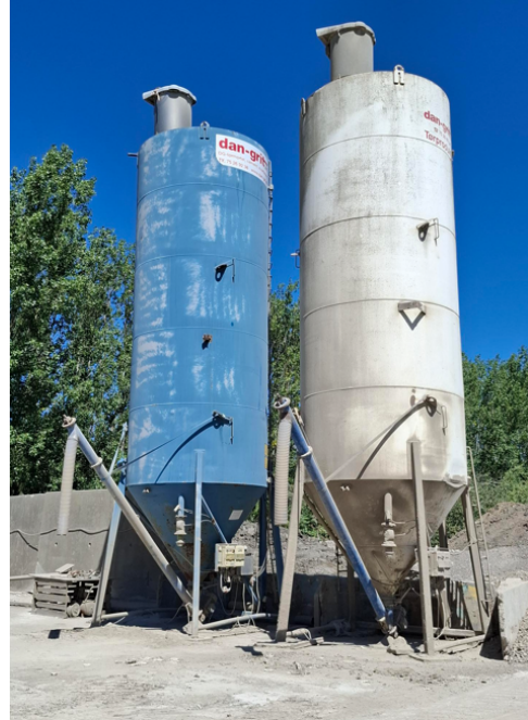
Foto 8. der tilsættes beton til jord. Dette kan være årsag til højt pH i spildevandet. Der udføres også kalkstabilisering.
