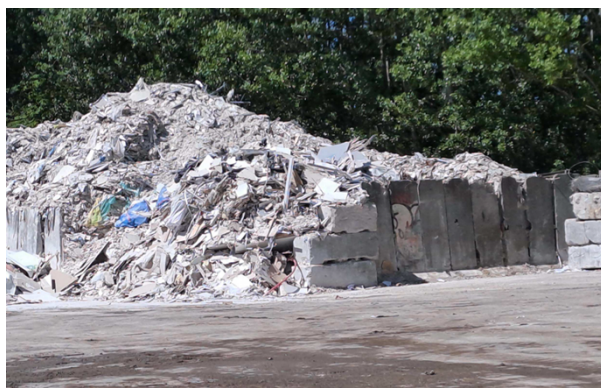
Foto 6. Gips – Bunken ligger meget tæt på skel og der er risiko for hegn vil blive mast og hvis vind at affald/støv blæser ud. Højden skal nedbringes.
