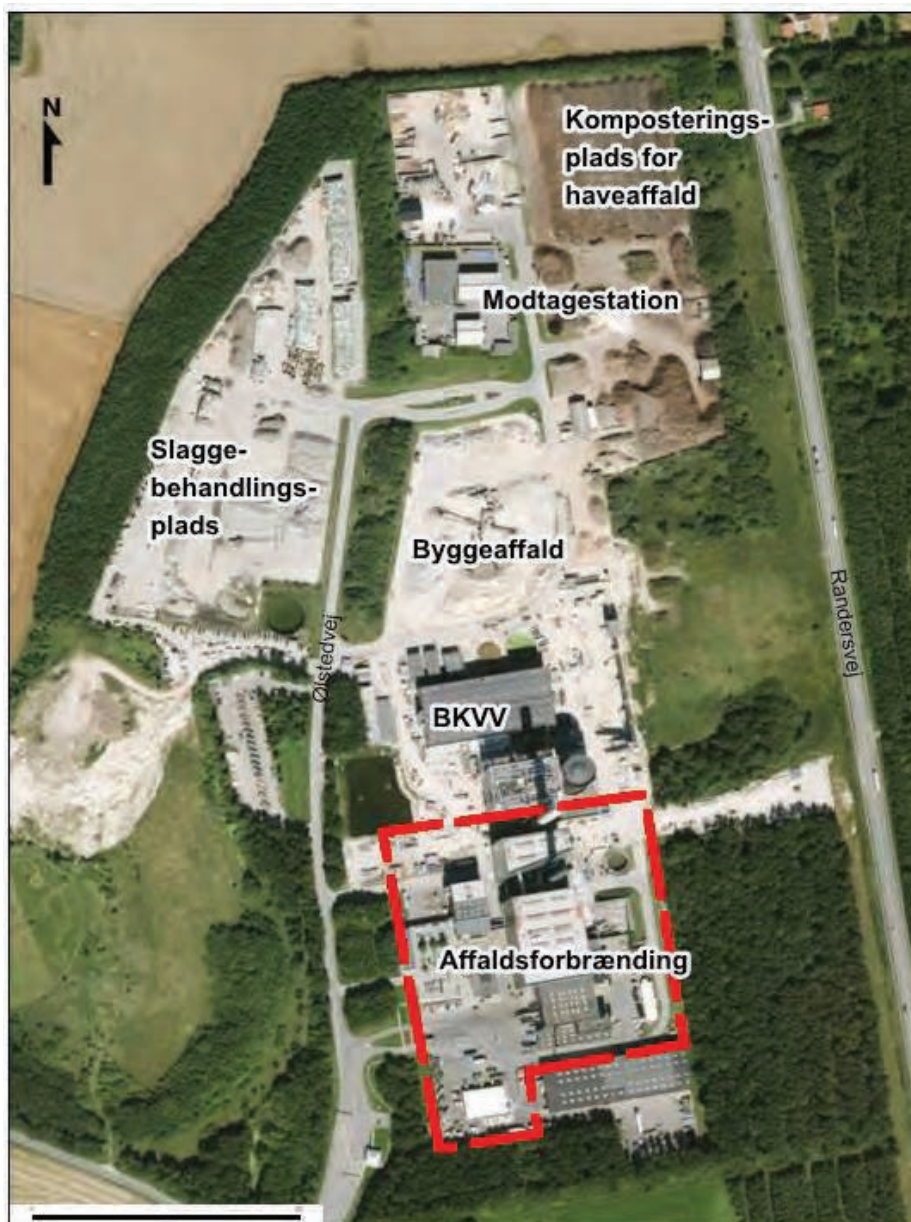
Figur 1 Oversigt over AffaldsCenter og placering af affaldsforbrændingsanlægget.
