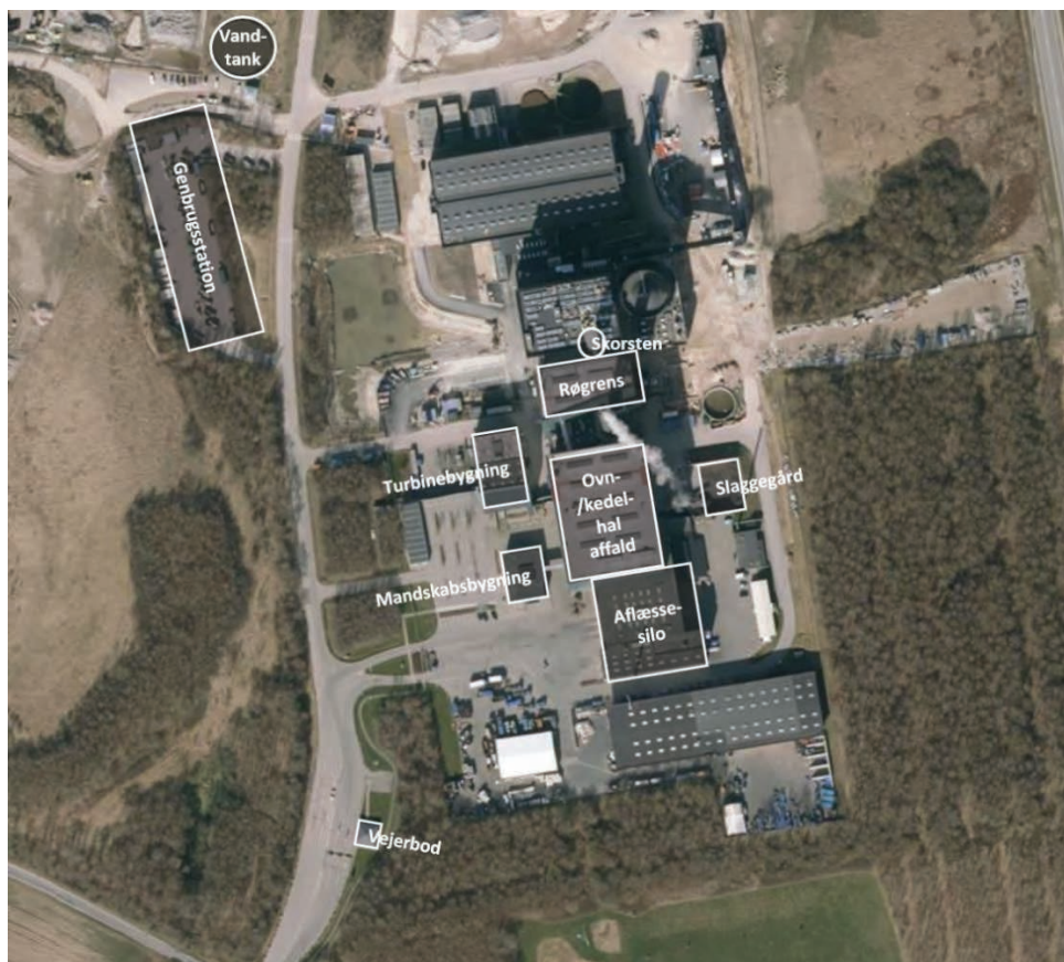
Figur 2 Placering af de enkelte anlæg på området for ACF. I den nordlige del af bygningsmassen ligger BKVV, som ikke indgår i denne miljøtekniske beskrivelse eller revurderingen, kun under kumulativ virkning af emissioner.
