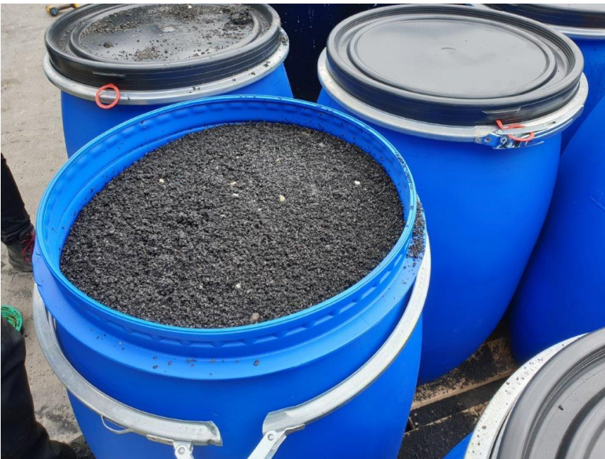
Spændelågsfade med brugt kulfilter materiale
