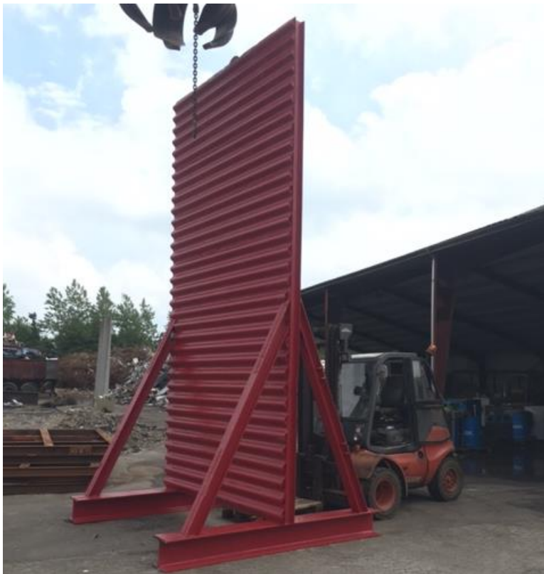
foto 1 - Færdigproduceret mobil støjskærm inkl. truck som flytter støjskærmen rund på pladsen.
