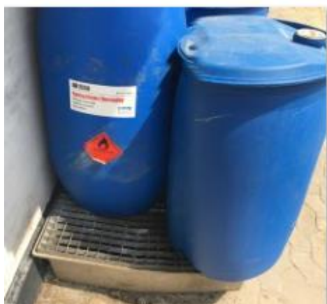
Foto 3: Affald placeret usikkert på spildbakken
