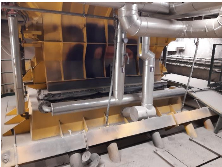
Photo 3 Sværtning efter tilbagebrænding i ovn/tragt foråret 2021
