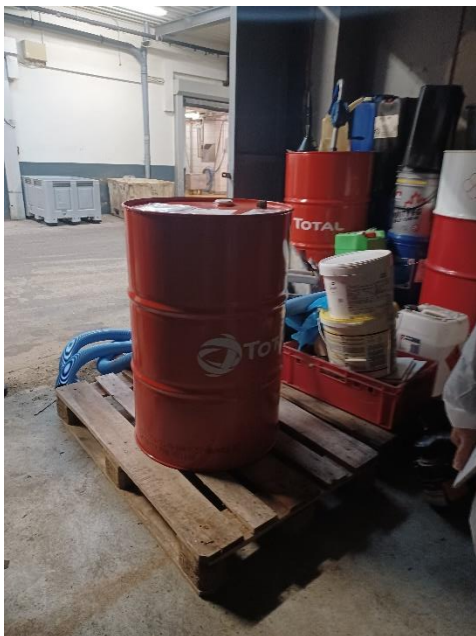
Oplag af olietønde unde opsamlingsbakke på virksomhedens lager.
