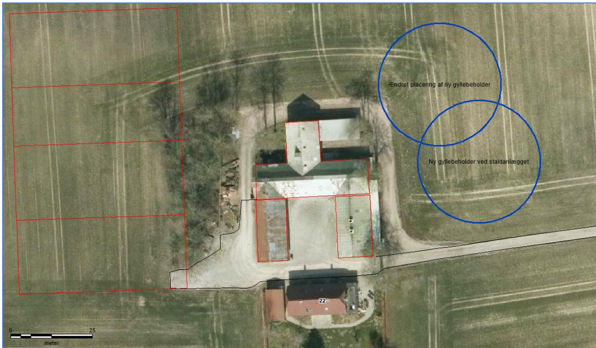
Figur 1: Den nye gyllebeholder placeres ca. 25 m nordnordvest for den placering, der tidligere er godkendt.
