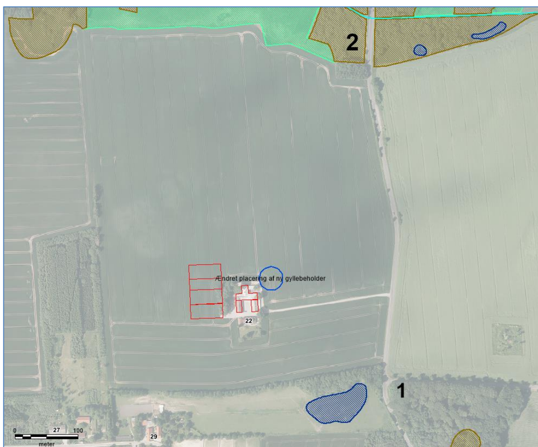
Figur 2: Den ændrede placering af gyllebeholder øger depositionen af ammoniak på § 3 beskyttet mose (punkt 2) og mindsker depositionen af ammoniak på ammoniakfølsom skov (punkt 1). Merdeposition med ammoniak på § 3 beskyttet mose (punkt 2) er fortsat mindre end 1 kg fra det samlede projekt, som er beskrevet med miljøgodkendelsen af 15. august 2016 og dette tillæg.
