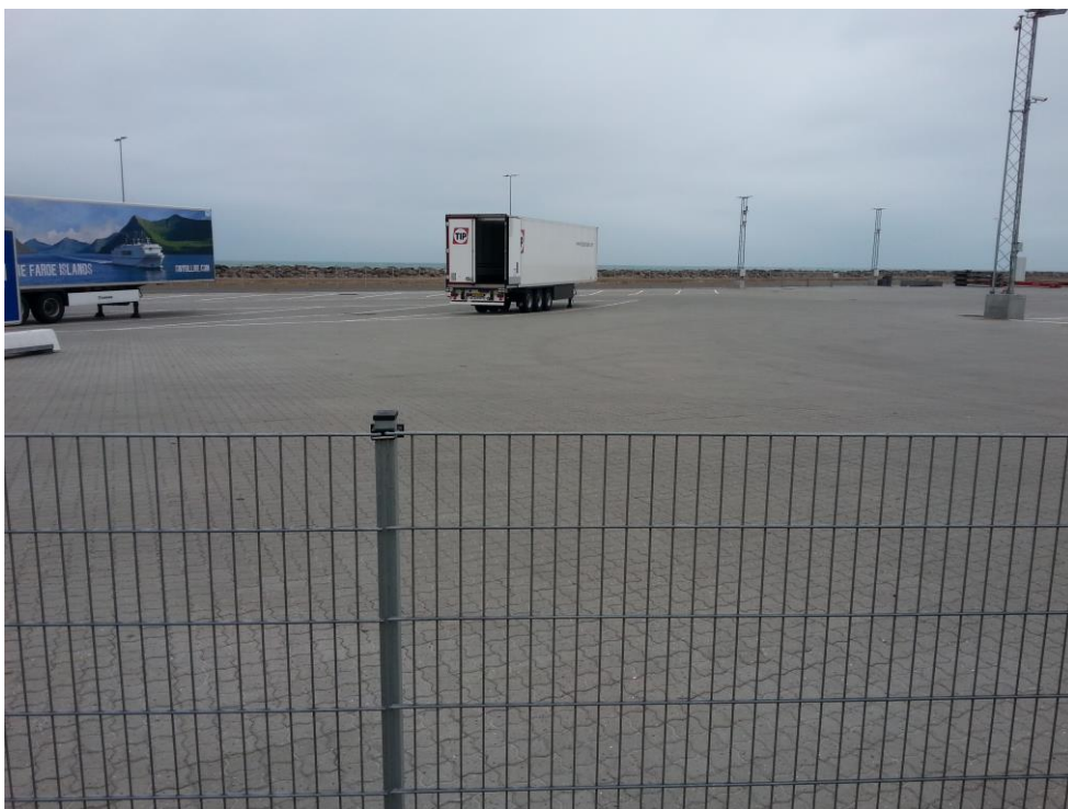
Hirtshals Havn. Det gamle deponi (enhed 1) bag østmølen på Hirtshals Havn. Det nu nedlukkede deponi er slutfærdiggjort og arealet belagt med sf-sten. Arealet benyttes til parkering/oplag ifm. færgeareal.
