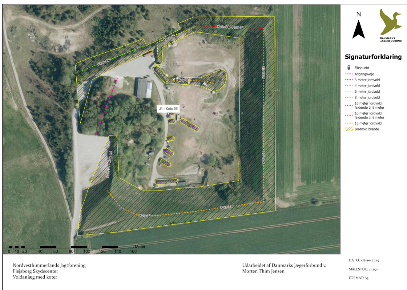
Figur 1. Koter, som anlægget må opbygges til.
