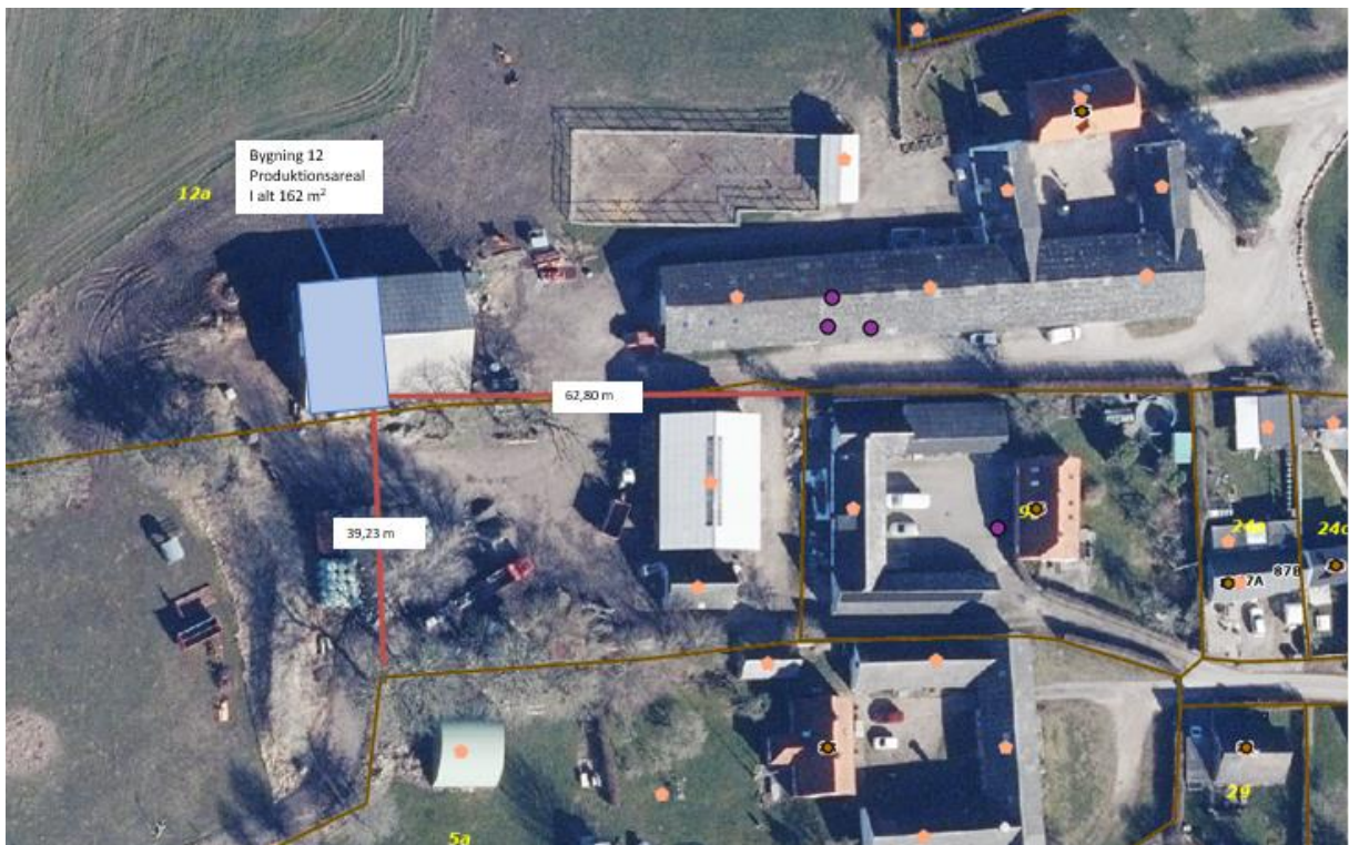
Figur 2. Afstandskrav, som ikke er opfyldt, for husdyr- og gødningsopbevaringsanlæg.
