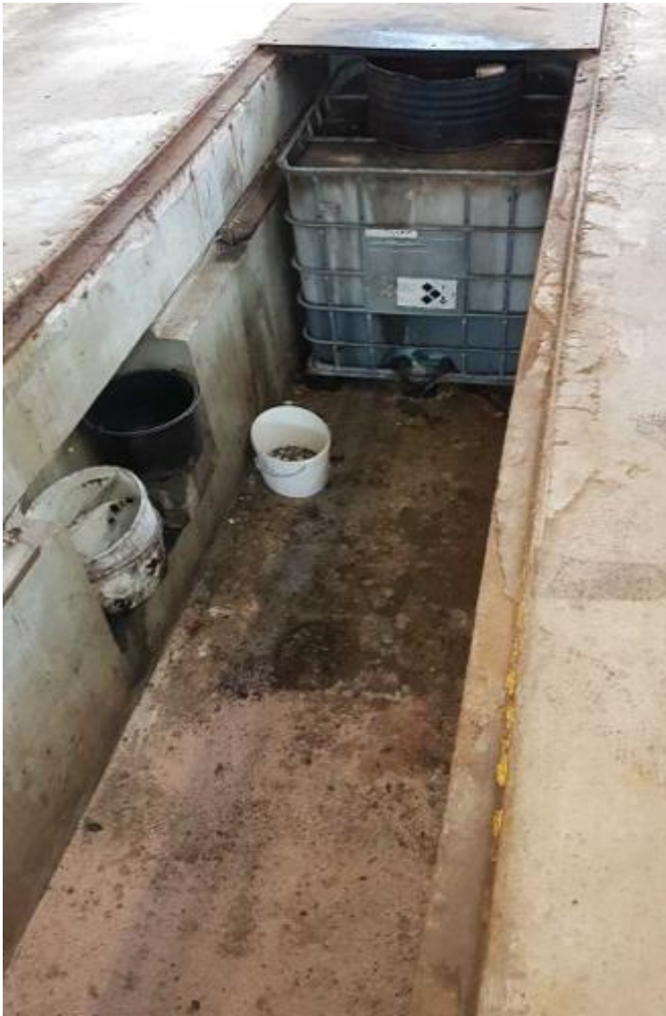
Opbevaring af spildolie og oliefiltre i pallettank i værkstedsgrav.
