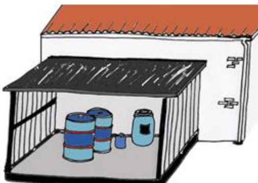
Figur 3 Udendørs opbevaring under tag med tæt bund og opkant.
