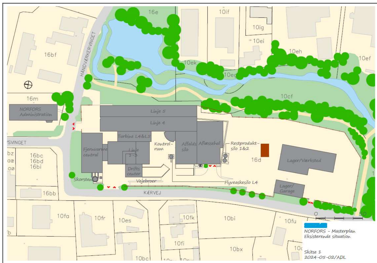
Figur 2.3: Situationsplan af Norfors sitet. Den mærkerøde firkant (ikke målfast) viser, hvor den midlertidige oplagsplads ønskes placeret. Den rigtige størrelse af oplagspladsen vil U-format med sider á 16 meter og bagvæg á 6 meter. Der vil være åbning på 6 meter på den side, der vender mod Kærvej.
