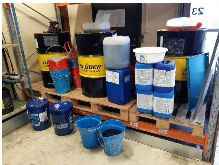
Spande med olie placeret i værkstedet uden for tæt opsamlingssted.
