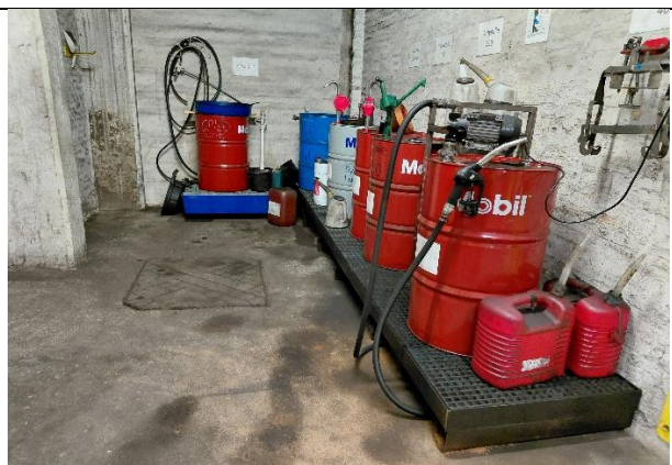
Opbevaring af forskellige olieprodukter på spildbakke i hal.
