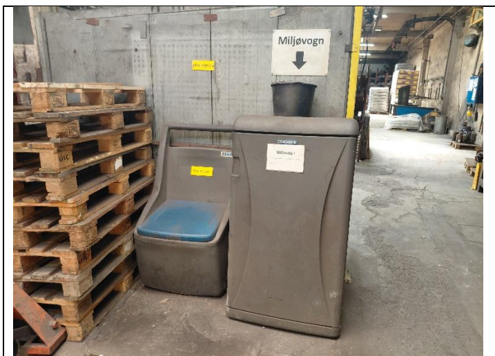
Miljøvogn, hvor alt der skal bruges til opsamling ved spild og andre miljøuheld er placeret
