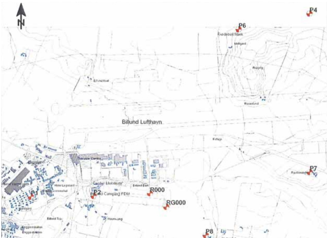
De 8 referencepunkter omkring lufthavnen, der anvendes i beregningerne af terminalstøj.
