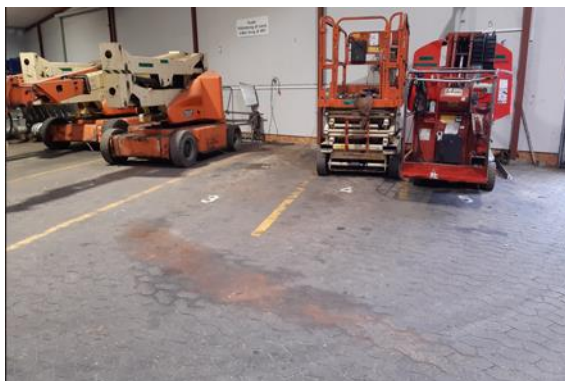
Fig. 1. Olieplet på gulvet i hal 40, hvor der har været lagt kattegrus ud til opslugning af spildet.
