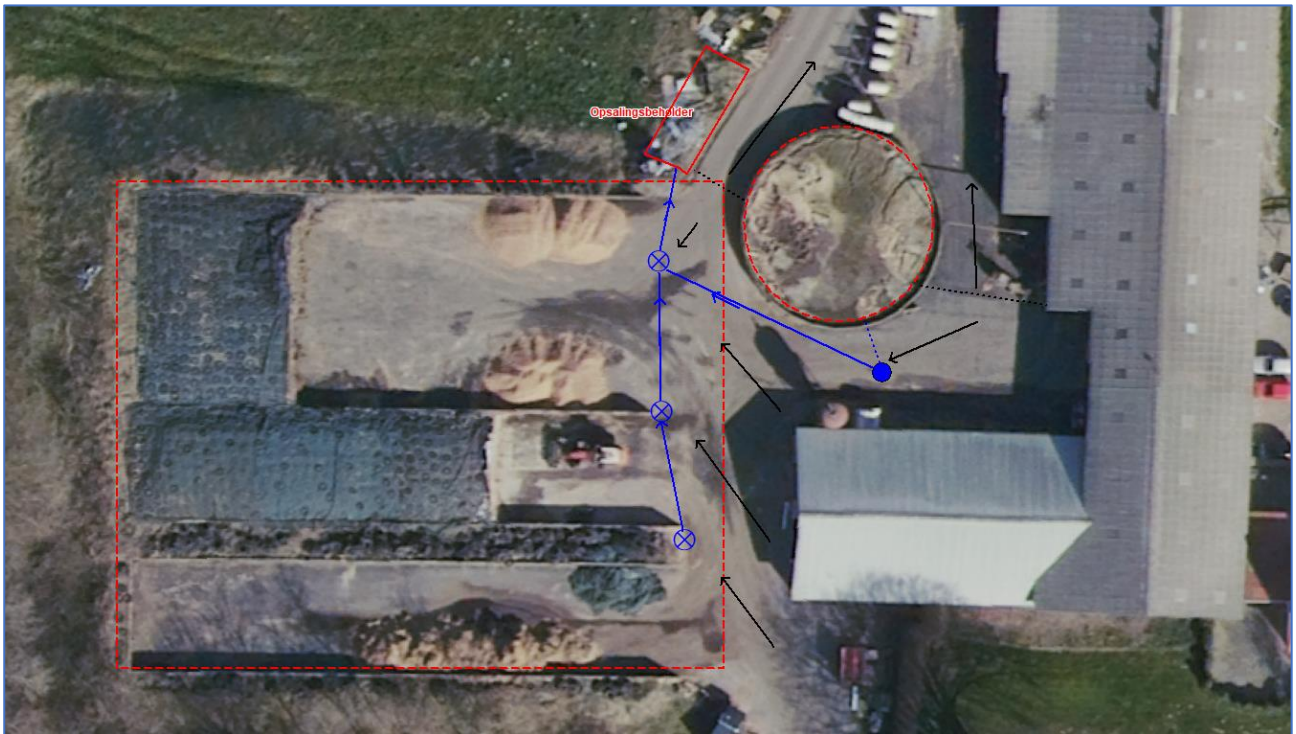
Figur 14, Indretning af plansilo og plads der ønskes ud sprinklet. De sorte stiplede linjer og sorte pile viser hvilken retning vandet løber.
