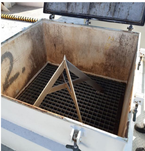
Figur 3 - skær på dækket, som åbner bigbags med foder. Fodersilo befinder sig neden for gitteret.
