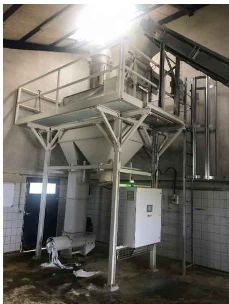
Billede 1. Ny Sækkeopsprætningsmaskine hal syd
