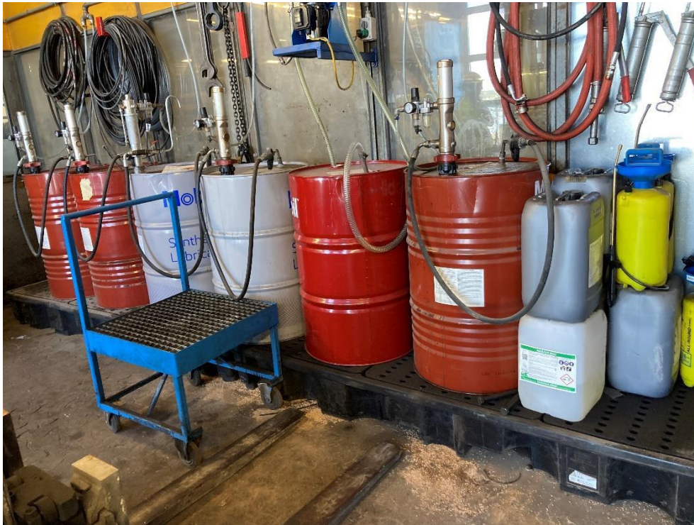
Korrekt opbevaring af flydende materiale på spildbakke i værksted v. havn
