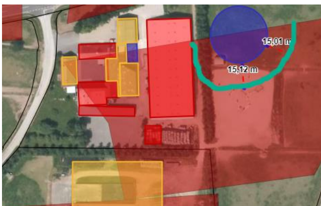
Figur 1. De røde områder indikerer at, der kan ligge dræn. De grønne markeringer viser hvor der med fordel kan laves en søgerende til dræn.
