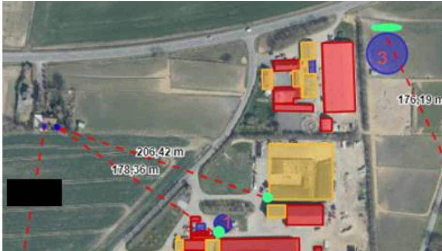
Figur 3. Grønne markeringer ved gyllebeholdere viser områder der skal pumpes og omrøres fra ved kontinuerlig udbringning af gylle
