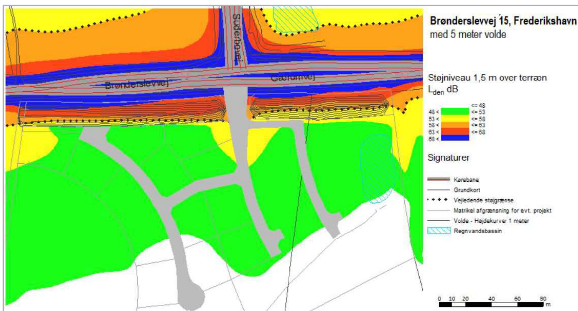
Figur 8: Visualisering af støjens udbredelse med 5 meter høje volde – 80km/t på Brønderslevvej/Gærumvej.
