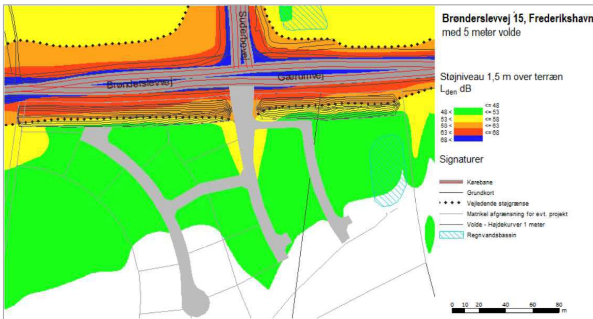
Figur 9: Visualisering af støjens udbredelse med 5 meter høje volde – 50km/t på Brønderslevvej/Gærumvej.
