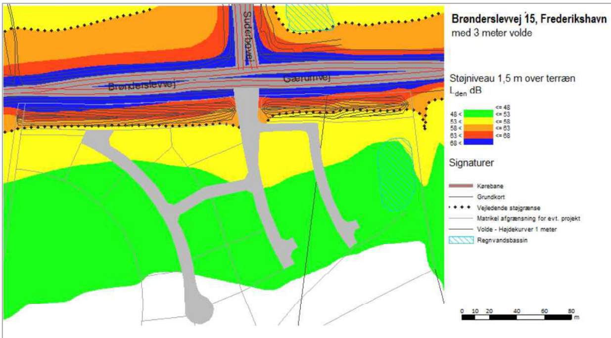
Figur 6: Visualisering af støjens udbredelse med 3 meter høje volde – 80km/t på Brønderslevvej/Gærumvej.
