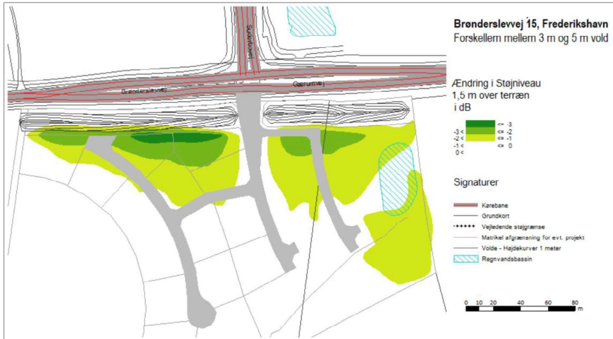
Figur 10: Visualisering af forskellen mellem 3 meter og 5 meter volde – 50km/t på Brønderslevvej/Gærumvej
