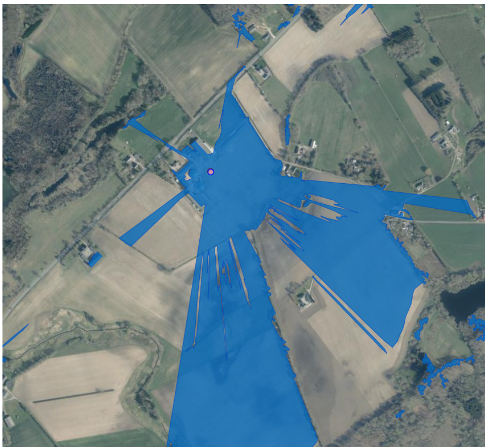
Figur 2: Synlighedsberegning over plansiloens placering. Elementhøjden er sat til 3 m, betragterhøjden er 1,5 m og radius fra plansiloen er 1.000 m. Det blå område er dér, hvor plansiloen er synlig, den lyserøde prik er plansiloens placering.
