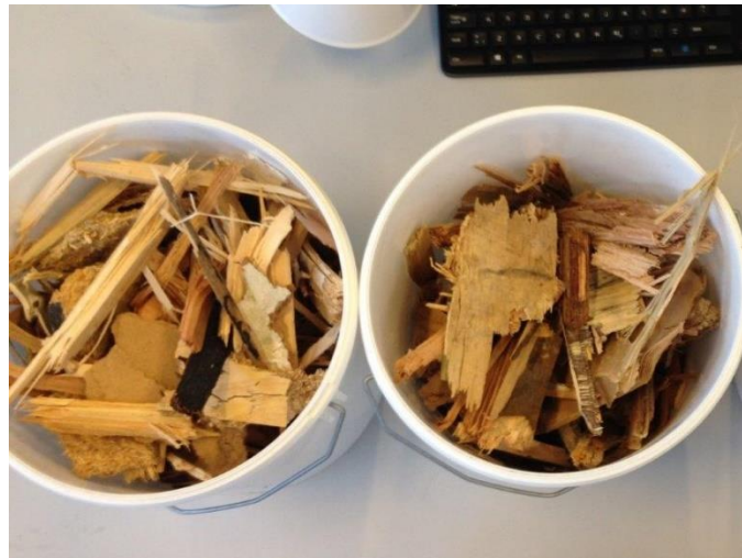
Billede 3: De to blandprøver med ikke-genanvendeligt træ i spande m. diameter og højde på 25 cm.
