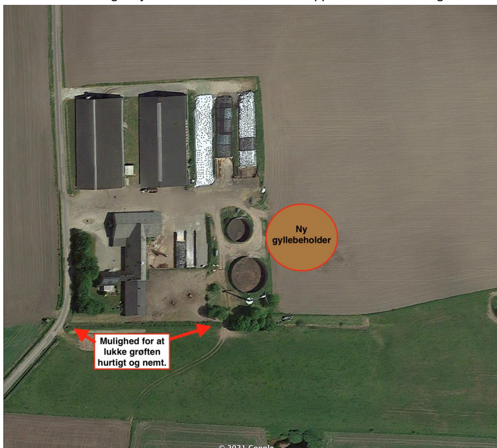
Figur 9: De røde pile hvis hvor det vil være hurtigt og nemt at lukke grøften ved et evt. udslip af gylle.
