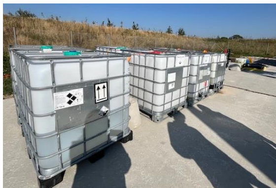
Foto 8: opbevaring af kaliumhydrooxid på plads ved PtX-demoanlæg
