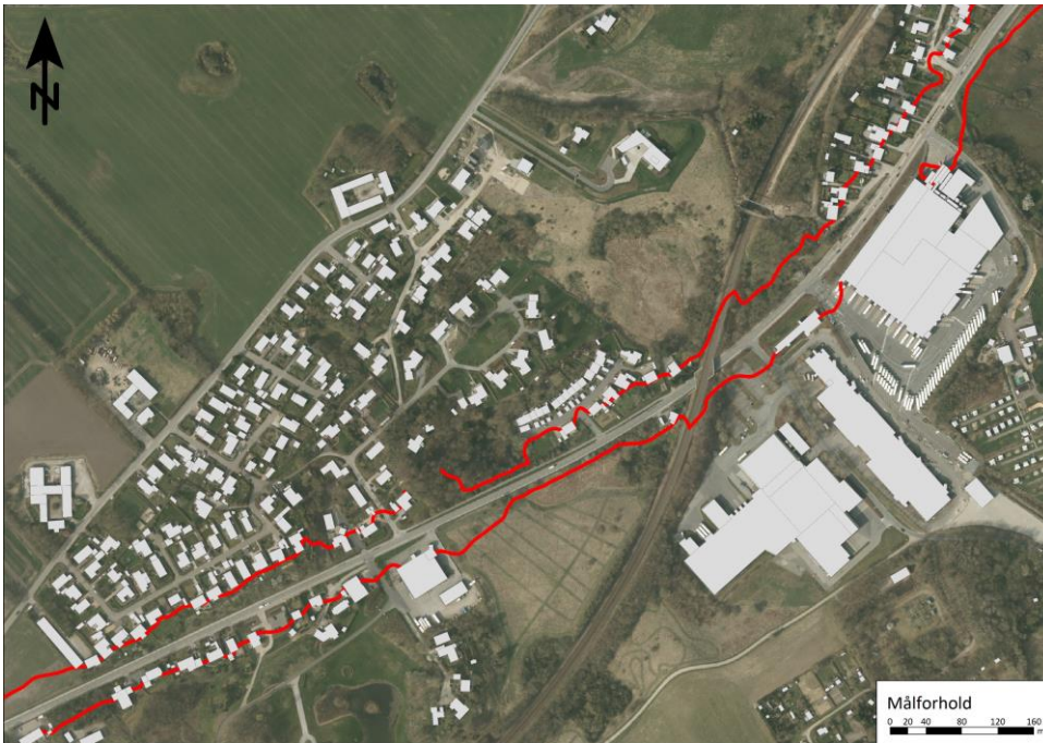
Figur 1: Støjudbredelse 1,5 meter over terræn for situation uden udvidelse. Rød linje er støjgrænse på 58 dB(A).
