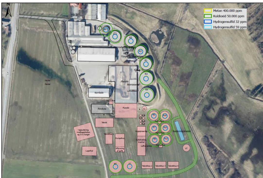
Figur IV.B.13 Spredning (Footcloud) af metan, kuldioxid og hydrogensulfid
