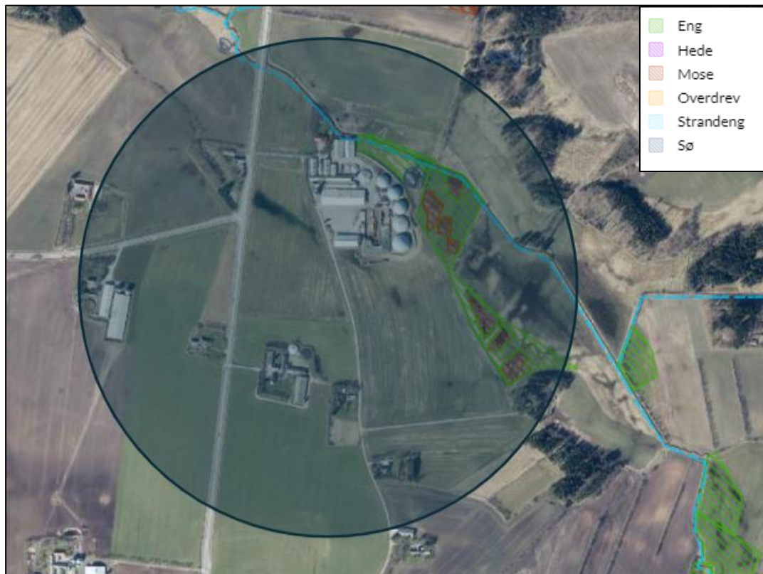
Figur II.D. Den maksimale konsekvensafstand på 600 meter, beregnet i programmet; scenarie -spredning af ammoniak.
