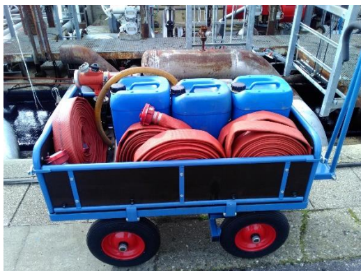
Foto 1: Trækvogn med brandslukningsudstyr til brandbekæmpelse.
