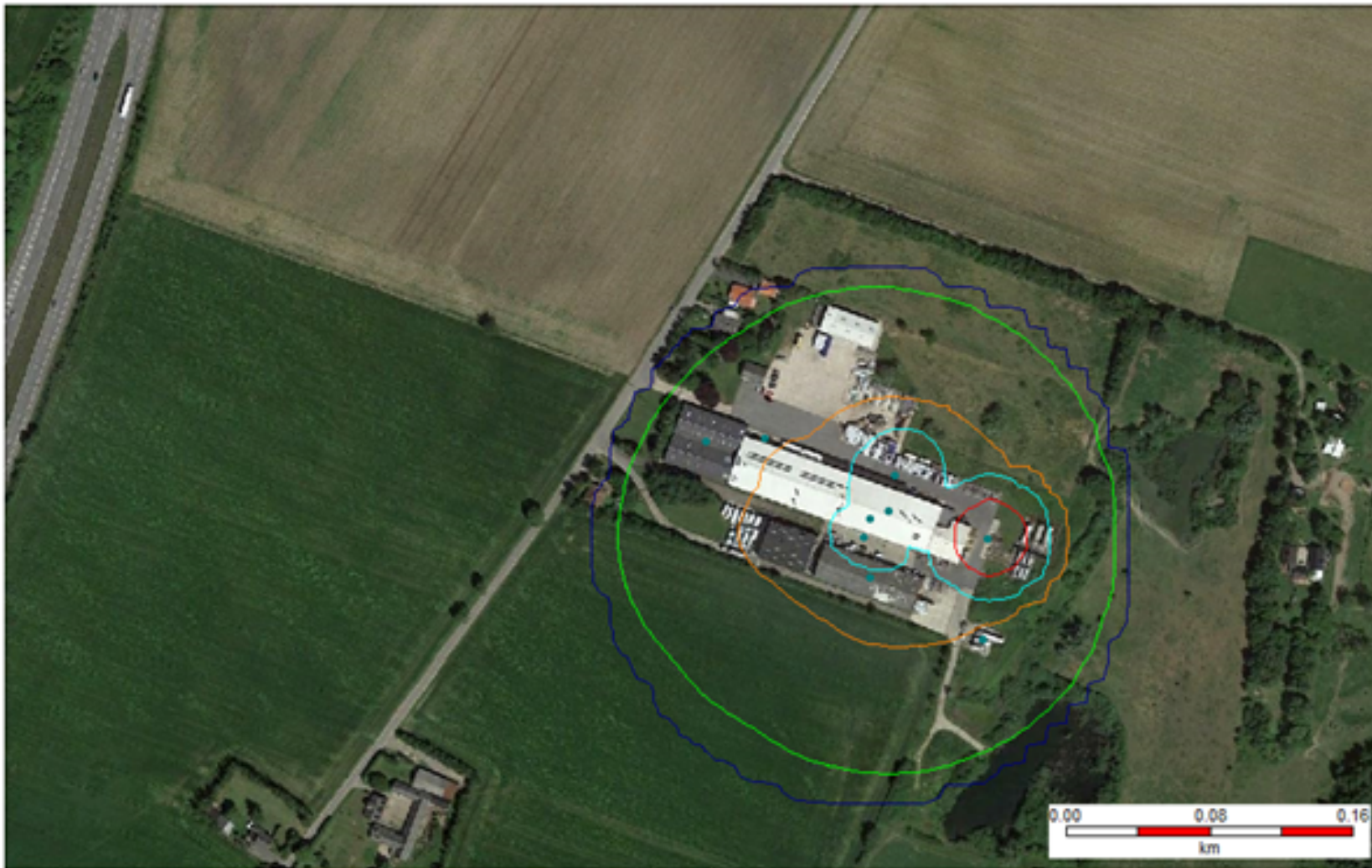
Figur 6-1 Beregnet stedbunden risiko for virksomheden med angivelse af sandsynlighed for dødsfald på henholdsvis 10^{-4} (rød), 10^{-5} (turkis), 10^{-6} som er accept kriterium (orange), 10^{-7} (grøn) og 10^{-8} pr. år (blå).
