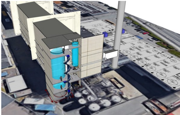
Fig 2: Ny gæringstank og podetank i tilbygningen for enden af bygning XN
