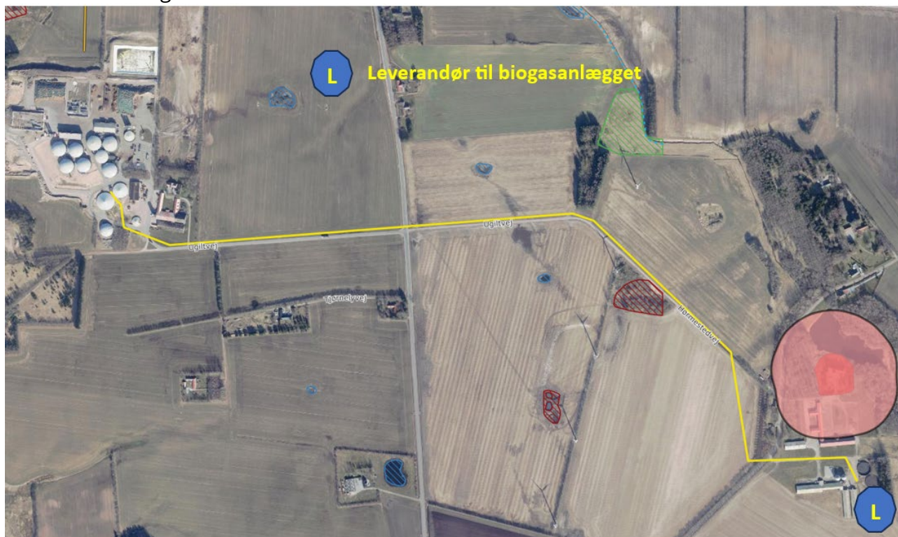
Figur 1 Pumpeledning fra fortank, Hørmestedvej, til modtagetank på biogasanlægget.
