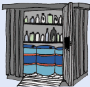
Figur 2: Udendørs opbevaring i container med dobbelt bund.
