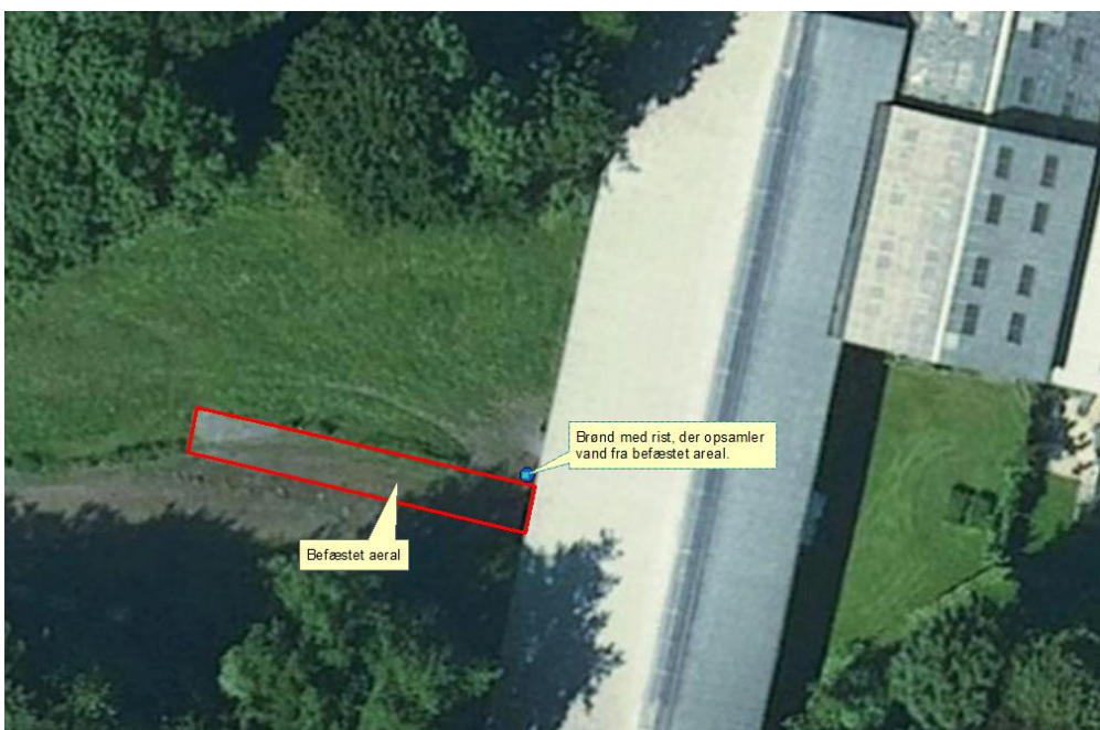
Figur 6. Brønd i forbindelse med befæstet areal.
