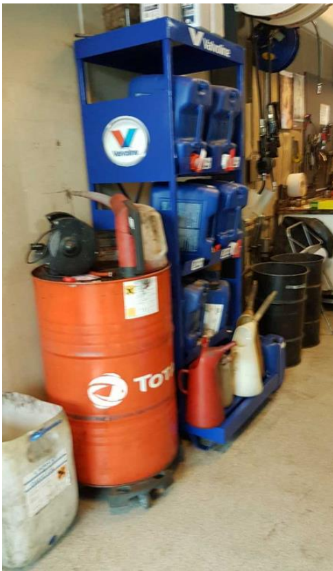
Mindre emballager til råvarer står i stativ med spild-/drypbakke. Tromle med kølervæske står uden spildsikring.
