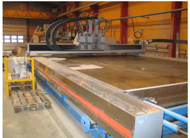
Foto 2: Vandstråleskæremaskine
