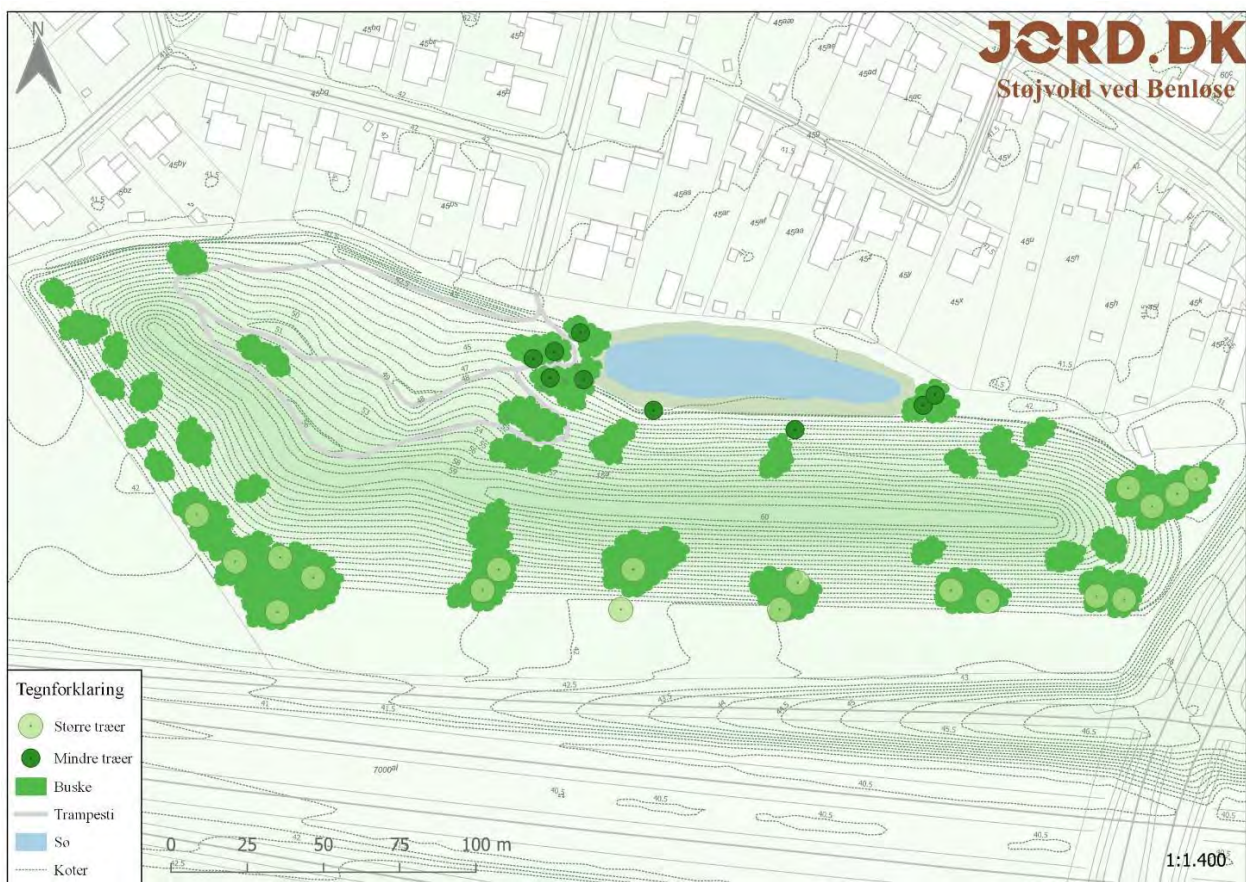
Figur 4. Tegning af volden med regnvandsbassin.
