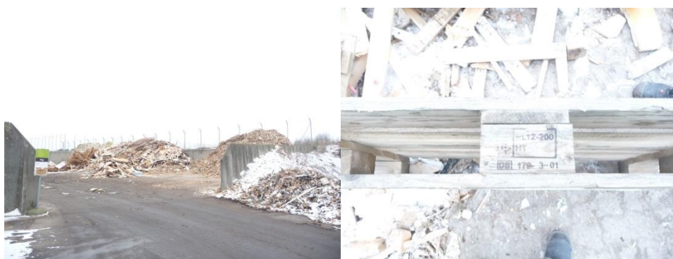
Figur 3 Pladsen til genanvendelige materialer primært træ. Palle med mærkning, der viser, at den er blevet varmebehandlet, og dermed ikke behandlet med kemikalier for at forhindre transport af insekter. (th).
