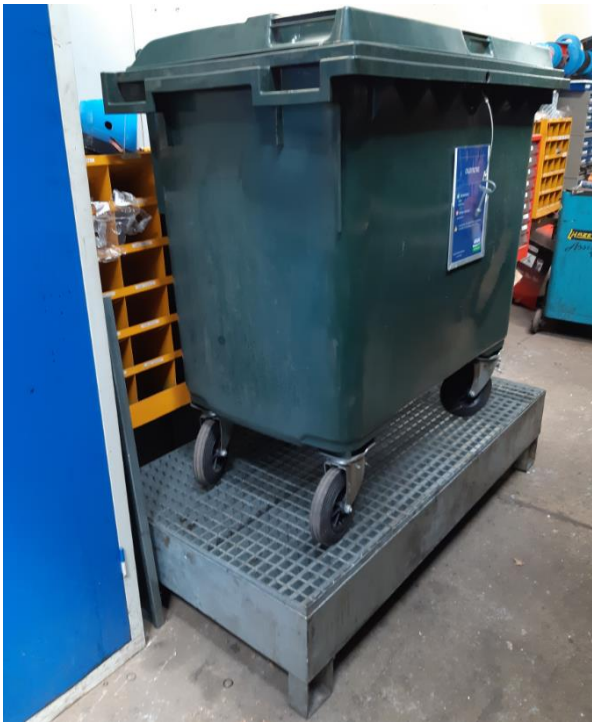
Container til oliefiltre på spildbakke
