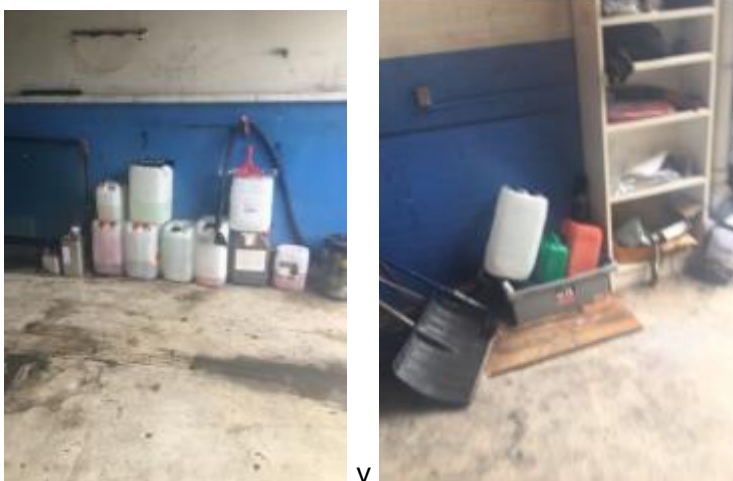
Foto 4: Opbevaring af dunke uden spildbakke eller stablet
