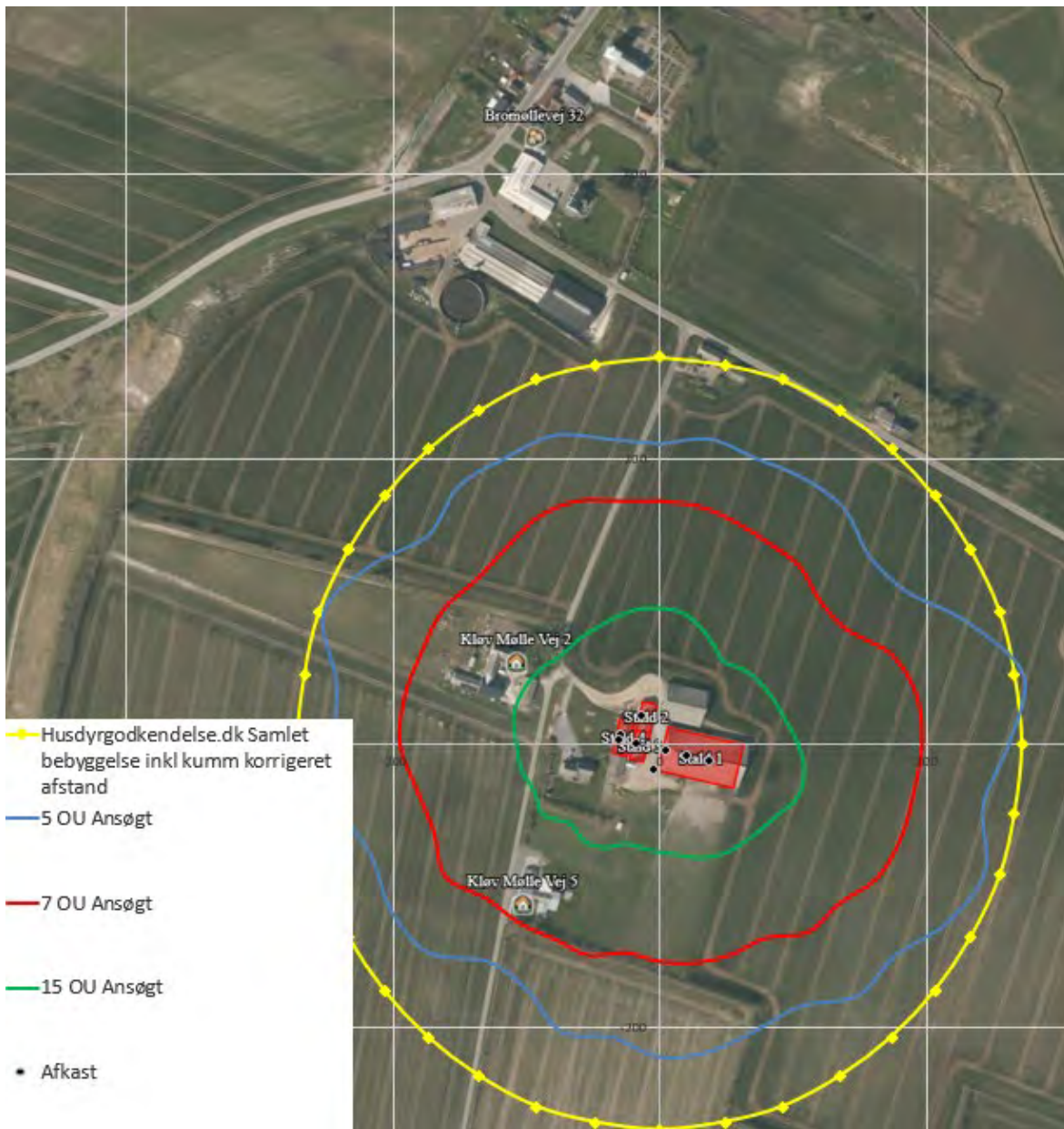
Figur 5. Grafisk visualisering af isokurver for lugtgene fra produktionen Trehøjevej 80 med hhv. ansøgt ventilationsdesign og genegrænsen til samlet bebyggelse inkl. Et kumulationsbrug udregnet i Husdyrgodkendelse.dk.
