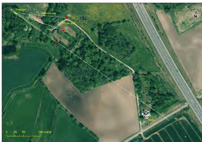
Figur 5 Placering af målepositioner for støjmåling udført d. 28. april 2018.
