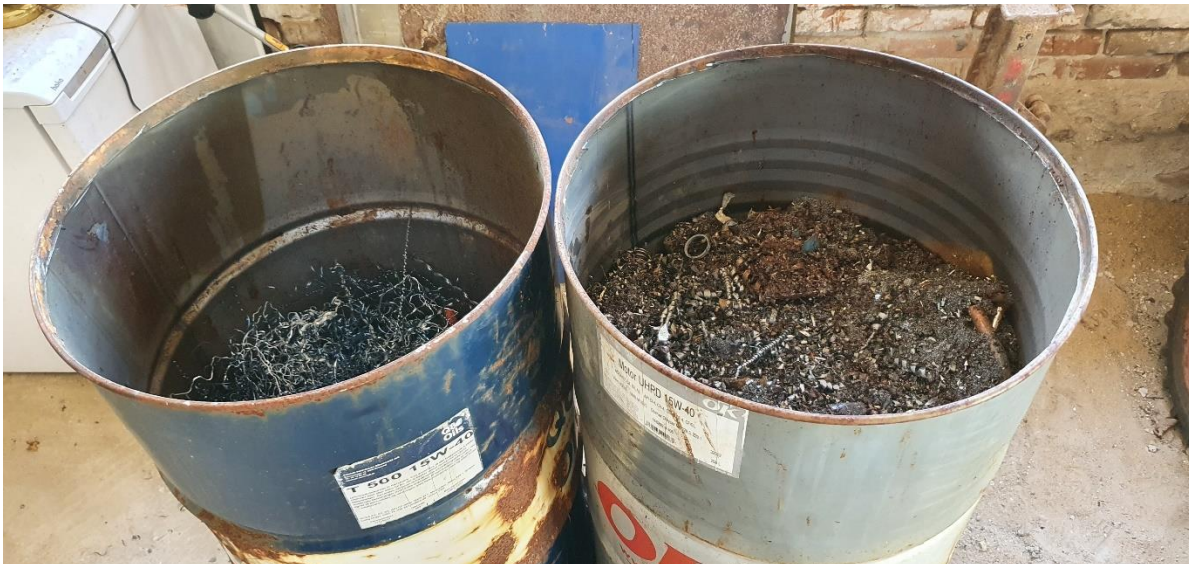
Metalspåner med køle-/smøremiddel opbevares indendørs i tætte tromler på betongulv uden afløb.
