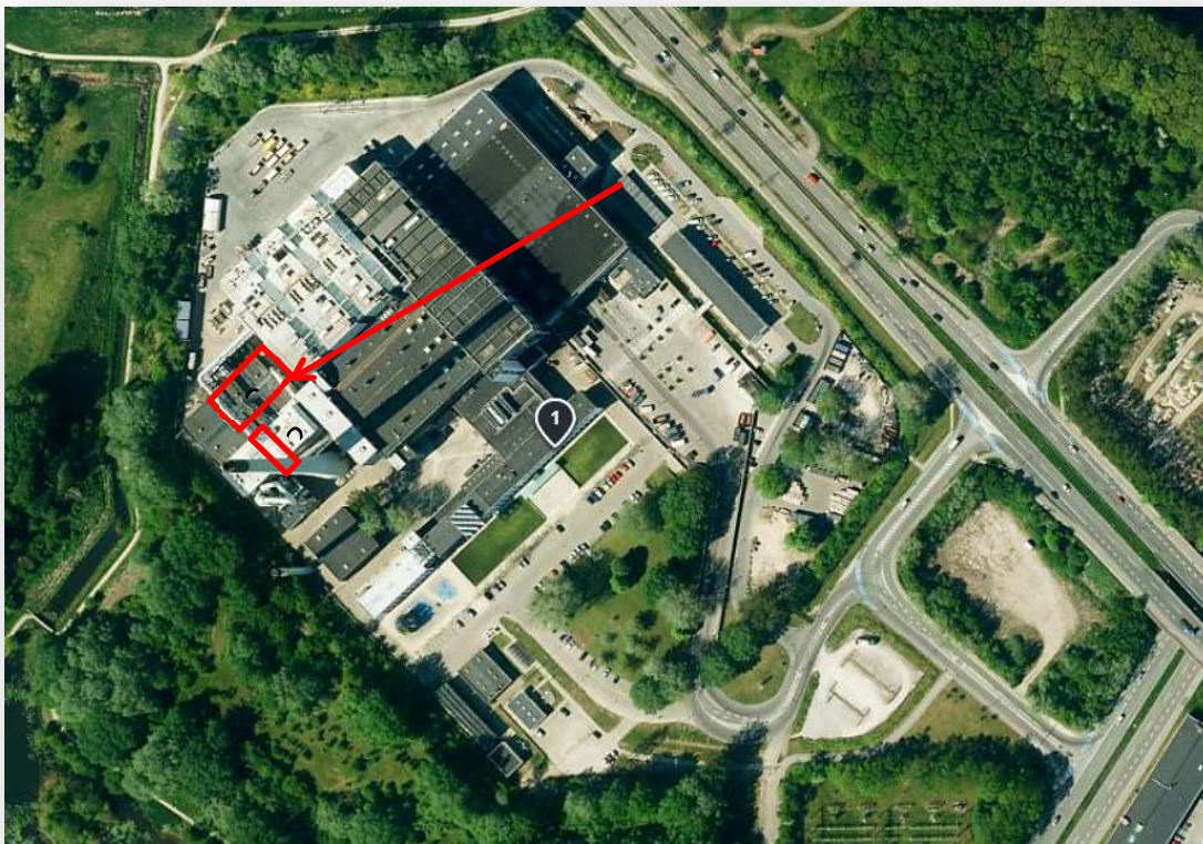
Figur 1. Situationsplan, som viser placering af det nye Halosep askebehandlingsanlæg på Vestforbrænding (angivet med rød ramme). Den lille røde ramme angiver placeringen af den lille tilbygning til udlastning af det behandlede røggasaffald indeholdende filterpresse og container-/trailerrum.
