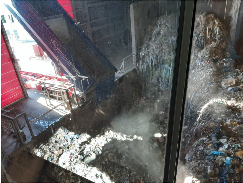
Udsynet for kranføreren, når minkene aflæsses i affaldssilo. Affaldsbunken bagerst i siloen er tørt erhvervsaffald til opblanding med mink
