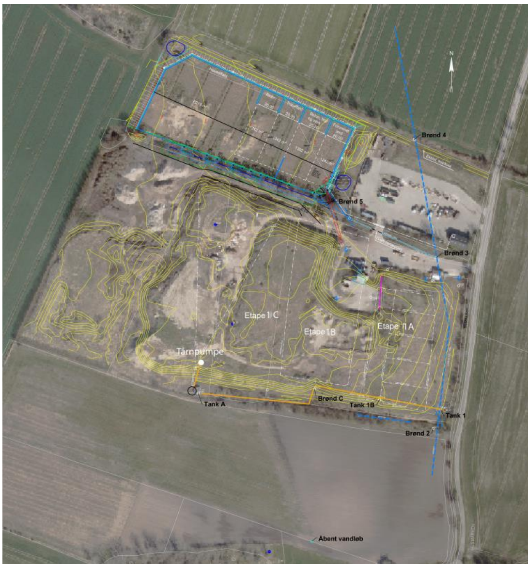
Figur 4. Perkolatbrønde: Tank A (etape 1C), brønd C (etape 1B), tank 1B (etape 1A) og tank 1 (pumpestation). Overfladevands prøvetagningssteder: Brønd 2-5, alt vand ledes til brønd 1 (åbent vandløb syd for anlægget).
