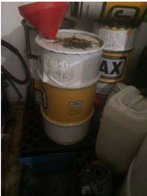
Flydende farligt affald og råvarer opbevares i værksted. Der anskaffes opsamlingsbakke
