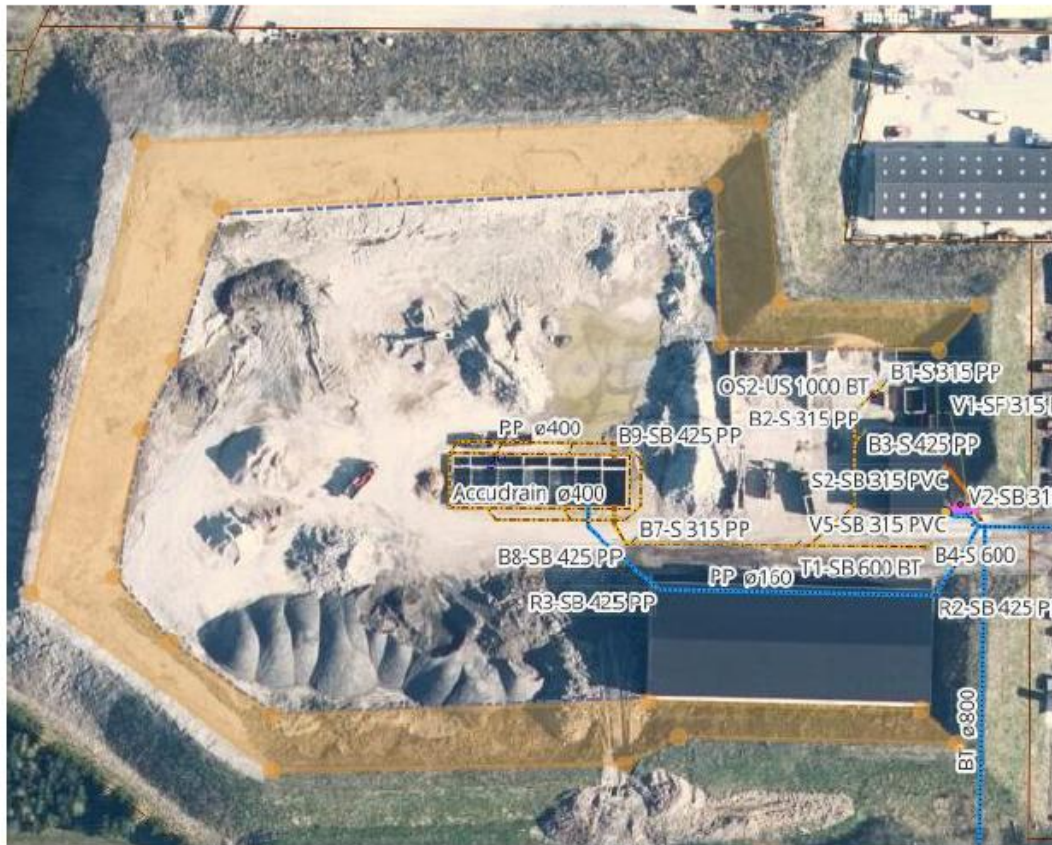
Figur 5 Areal på vold, som potentielt kan afvande til infiltrationen er 7685 m 2
