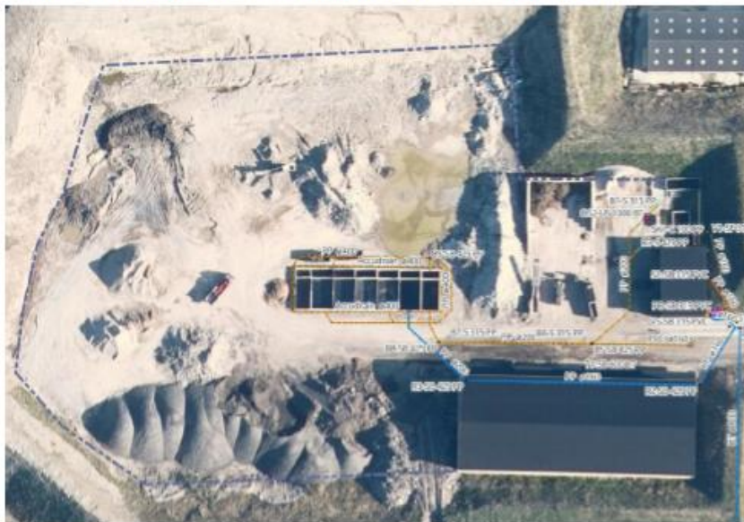
Figur 1 Behandlingsplads med omkransende betonvæg, der skal tjene til adskillelse mellem rene og ikke rene materialer.
